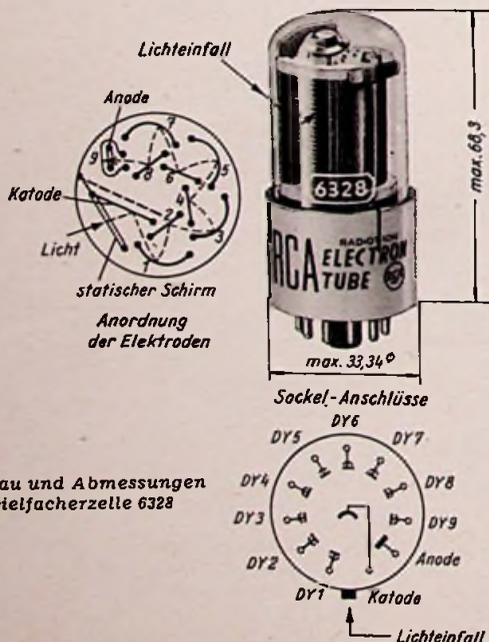
Bild 1. Aufbau und Abmessungen der Vervielfacherzelle 6328
