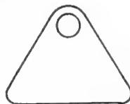
Bild 2. Zuschnitt für den Stützfuß
